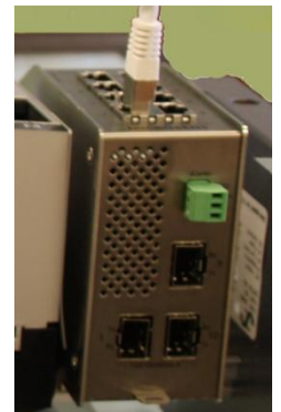
Trois accès SFP Fibre et sortie alarmes
